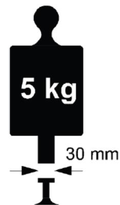
Die Vorrichtung zur Messung der Dicke von Kleidung und Schuhen muss einen Zehntelmillimeter (0,1 mm) messen können. Die Messungen müssen mit einem Gewicht von 5,0 kg durchgeführt werden. Die Vorrichtung muss zwei (2) kreisförmige flache Oberflächen haben, die einander zugewandt sind und jeweils einen Durchmesser von 30 mm haben.
